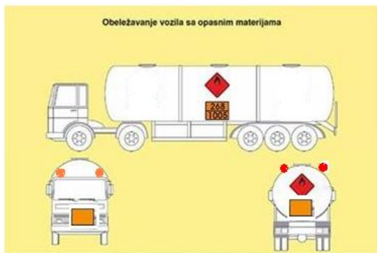
Слика 5.4 Обележавање возила
