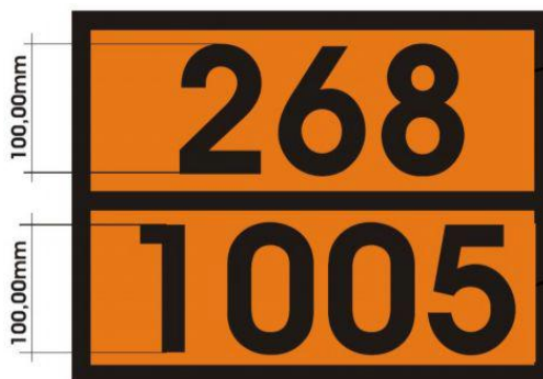
Слика 5.3: Пример табле за обележавање опасне материје класе 2 (амонијак, безводни)
