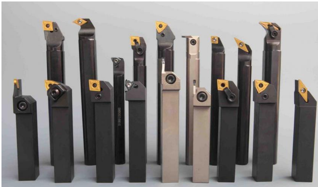
Слика 3.2. Стругарски ножеви са механички причвршћеним плочицама [9]
