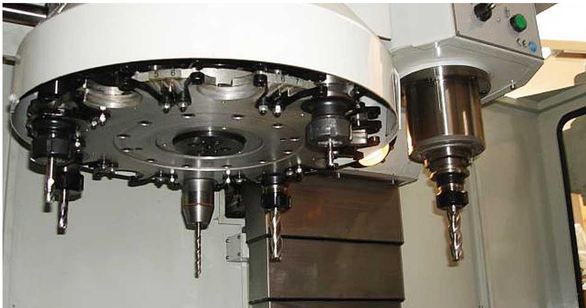
Слика 3.1. Пример магацина алата код CNC машина [9]
