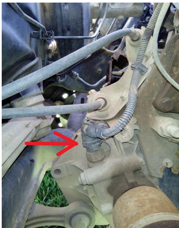
Слика 20 Пример уградње индуктивног давача брзине кретања на возилу FIAT PUNTO CLASSIC
