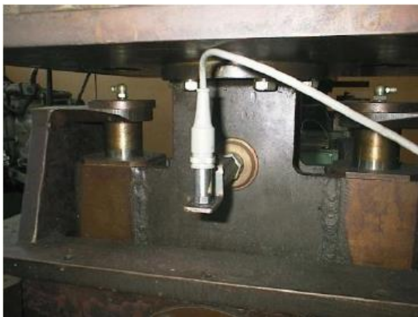
Слика 17 Постављање давача убрзања на осцилаторни тањир пулзатора
