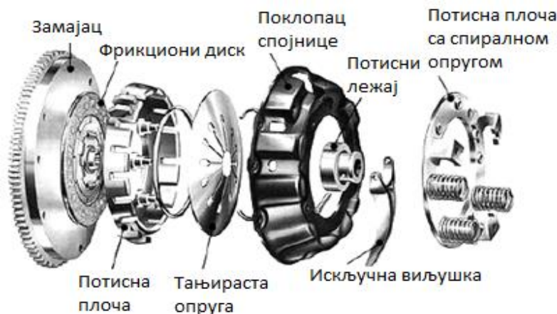
Слика 3.2. Основни елементи фрикционе спојнице[2]
