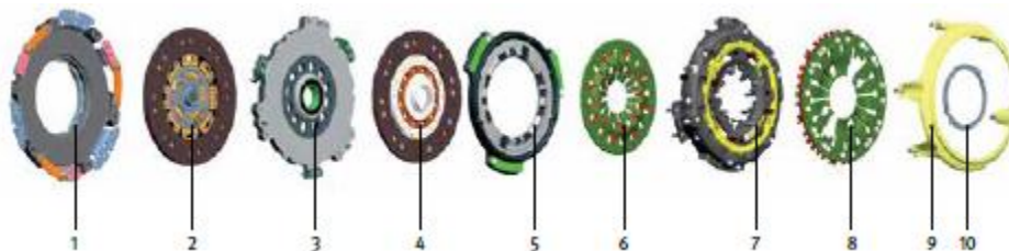
Слика 4.9. Елементи двоструке спојнице: 1. погонски прстен са притисном плочом, 2. фрикциони диск 1, 3. средишња плоча, 4. фрикциони диск 2, 5. притисна плоча, 6. тањираста опруга са механизмом за подешавање фрикционог диска 2, 7. корпа спојнице са механизмом за подешавање фрикционог диска 1, 8. тањираста опруга, 9. спона, 10. зауставни прстен [9]
