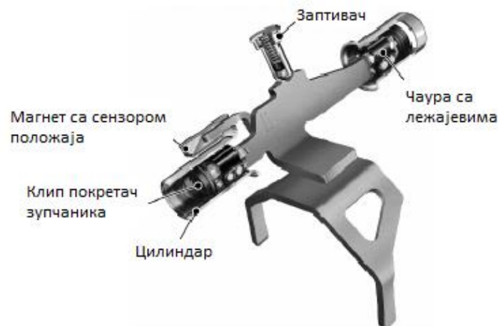
Слика 4.21. Виљушка са чаурама за промену 1. и 3. степена преноса
