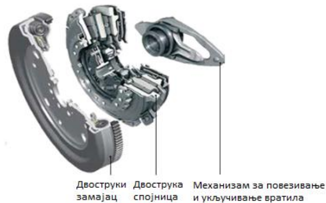
Слика 4.8. Систем за пренос снаге са код возила са DCT мењачем [9]
