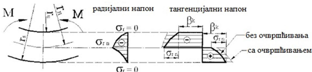
Слика 2.24 - Промена напона код чисто пластичног савијања
