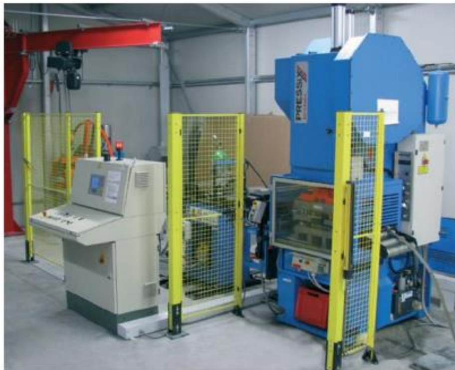
Слика 4.2 Механичка преса на коју се најчешће поставља корачни алат [8]
