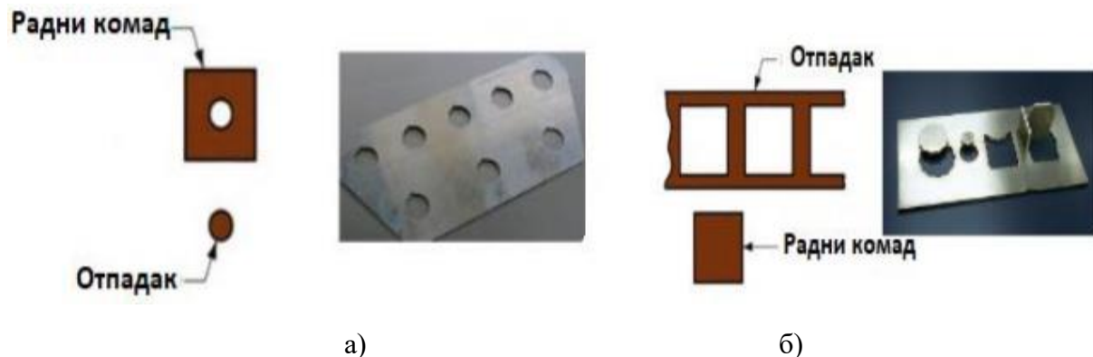
Слика 2.2 Пробијање (а) и просецање (б) [4]
