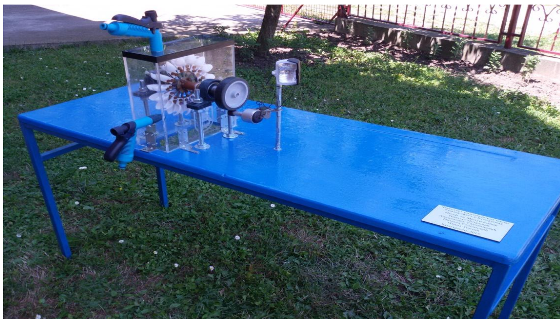
Слика 55 Приказ лабораторијског модела МХЕ са Пелтоновом турбином
