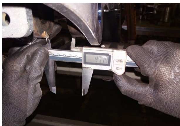
Слика 18. Растојање између унутрашњих лаша пре машинске обраде
