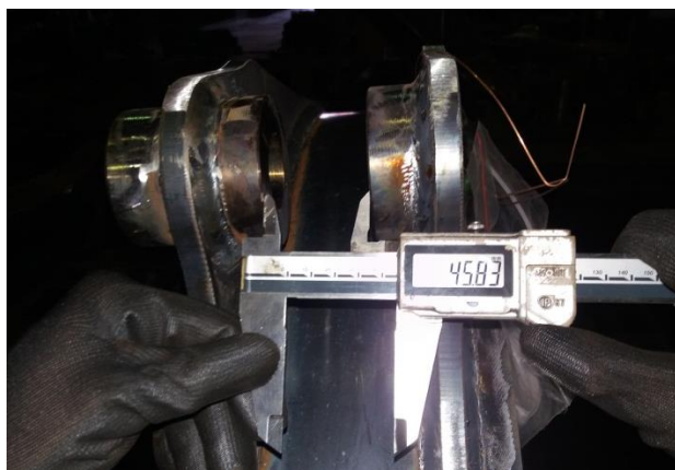
Слика 18. Растојање између спољних лаша пре машинске обраде
