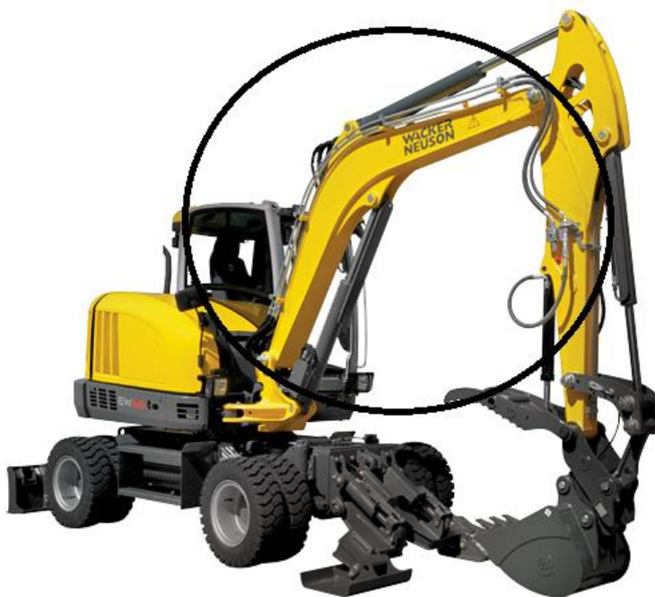
Слика 9. Багер EW 65 фирме Wacker Neuson са означеним делом који се прати у производњи [8]
