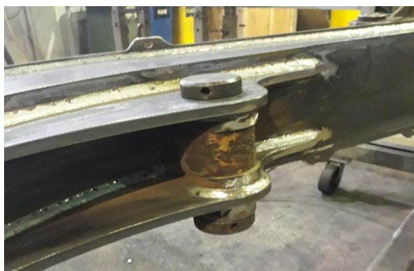
Слика 19. Одстојник између унутрашњег пара чаура
