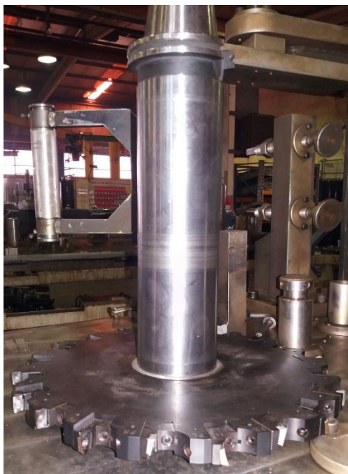
Слика 15. Диск са измењивим касетама и сребрним плочицама
