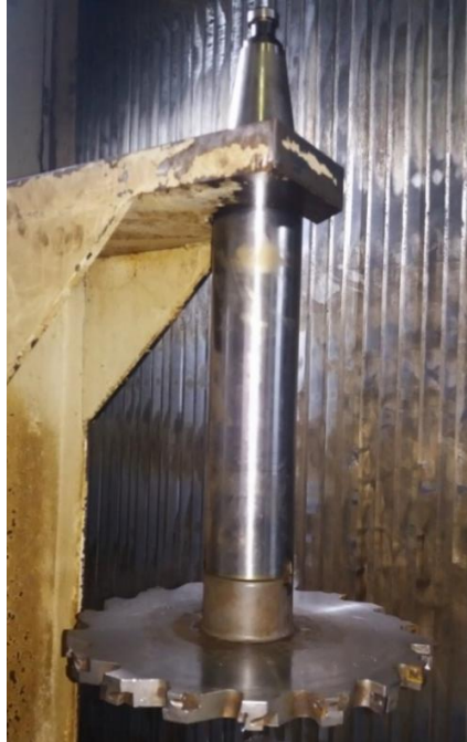
Слика 13. Котурасто глодало пречника 315 са стаблом дужине L=570mm и уградним плочицама
