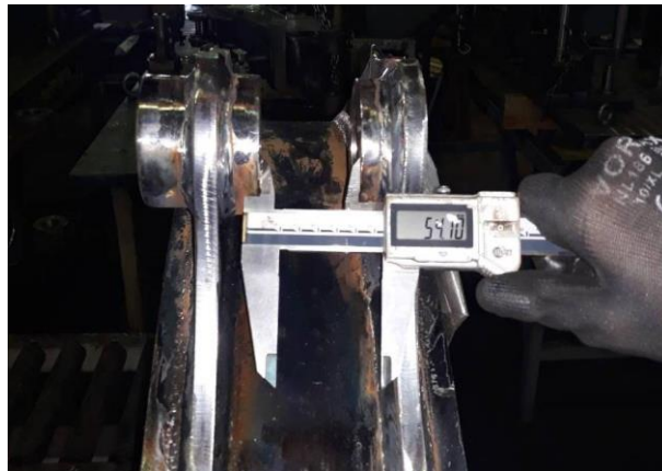
Слика 21, 22 Провера мера између спољних и унутрашњих чаура након склањања одстојника
