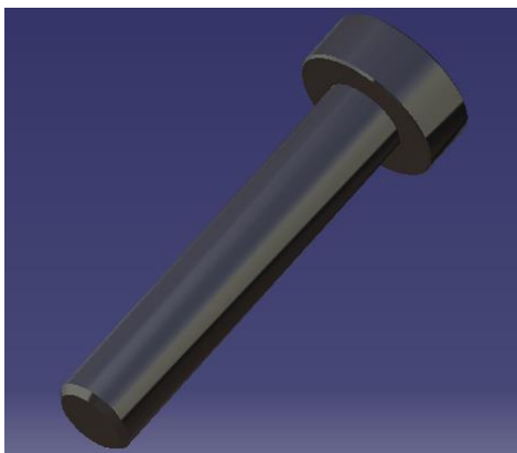
Слика 23 3D модел навојног вретена моделиран у програму CATIA
