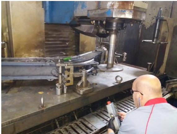
Слика 17 Позиционирање помоћу глодала
