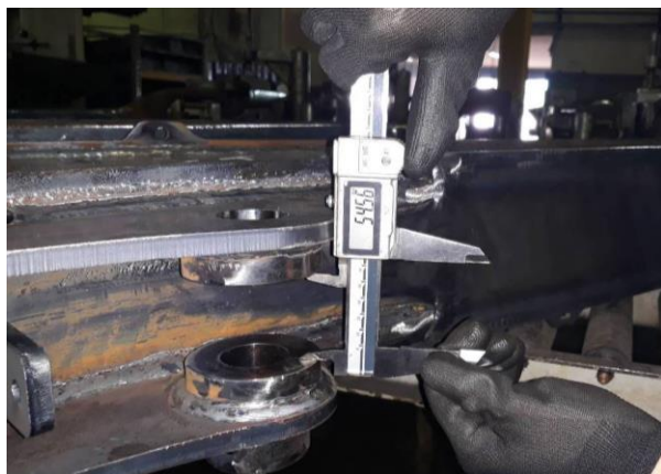
Слика 21, 22 Провера мера између спољних и унутрашњих чаура након склањања одстојника
