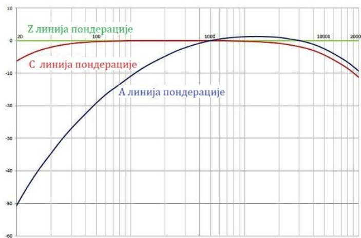
Слика 15 – A , C и Z тип еквивалентног непрекидног пондерисаног нивоа [7]
