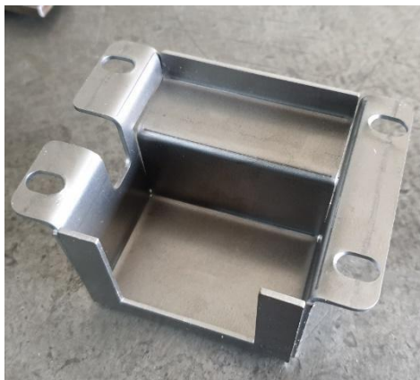
Слика 3-1 Изглед дела израђеног од танког лима
