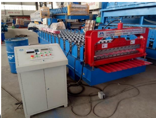
Слика 2-4 Машине за профилно савијање лимова: а) машина за обраду табли од лима; б) машина за израду профила од лима
