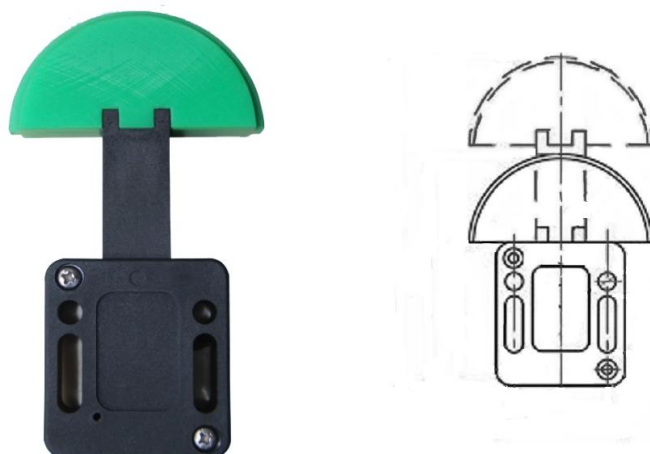
Слика 26. Затезни механизам са самоподмазујућим материјалом, [12]
