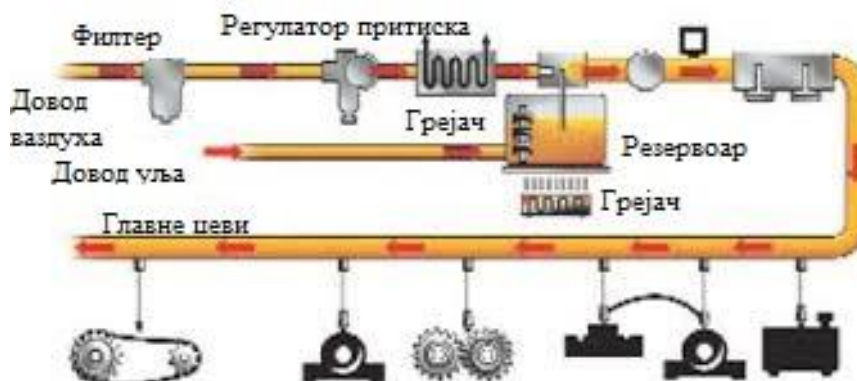
Слика 10. Шема система уље-ваздух, [7]
