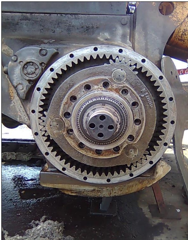
Слика 4.34 Слика отвореног планетарног редуктора (скинут поклопац)
