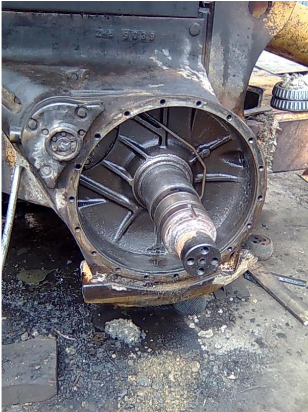
Слика 4.40 Осовина планетарног редуктора (осовина зглоба рама гусеница)
