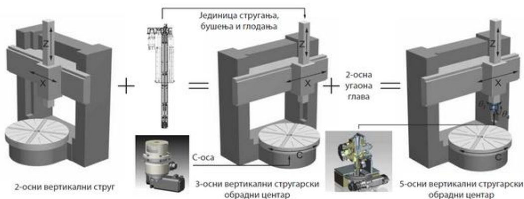
Слика 3.6 Концептуална решења двоосних глодачких глава [5]
