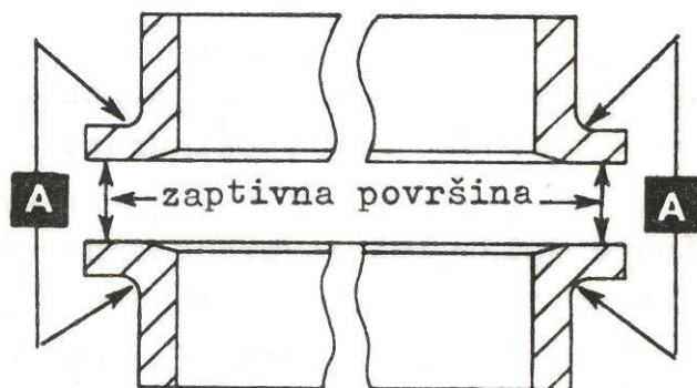
Слика 4.21 Површине налегања гумених прстенова и заптивне површине
