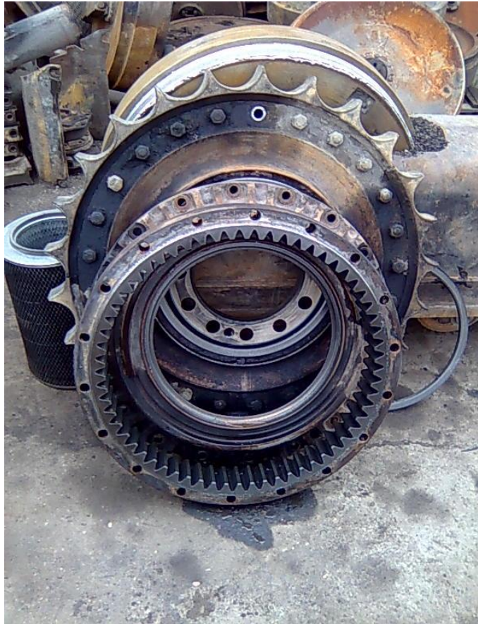
Слика 4.41 Демонтирани делови планетарног редуктора: прстенасти зупчаник, поклопац редуктора и ланчаник (погонски точак булдозера)
