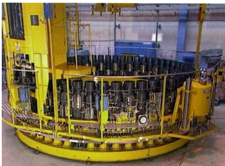
Слика 8.1. Уређај за затезање са вишеструким главама, употребљаван за нуклеарну реакторску посуду
