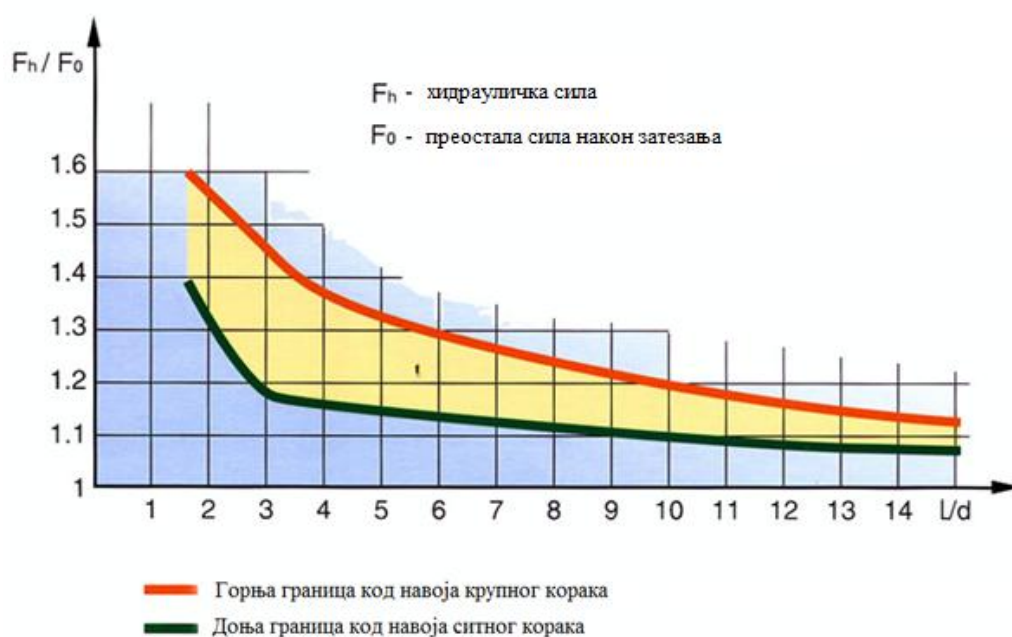
Слика 5.4.1.3. Дијаграм зависности F_h/F_0 од L/d код завртњева, за уобичајене врсте челика
