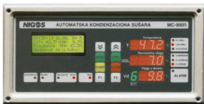
Слика 17: Аутомат за вођење процеса сушења [5]
