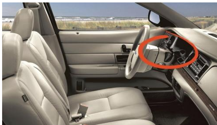
Слика 29. Мењач монтиран на стубу
