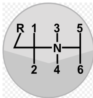
Слика 26. Шестостепени мењач брзина [3]
