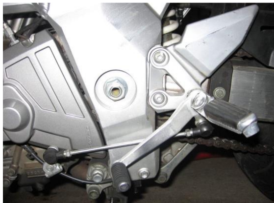
Слика 34. Секвенцијали мењач на мотоциклу Suzuki SV650S [3]
