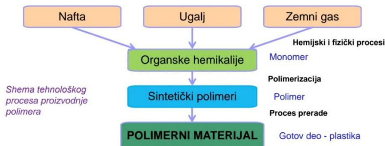
Слика 2.6. Технолошки процес производње полимера [2]
