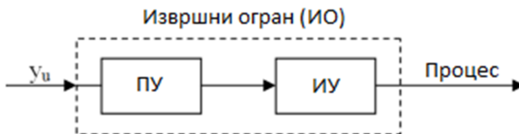
Слика 13. Блок дијаграм актуатора
