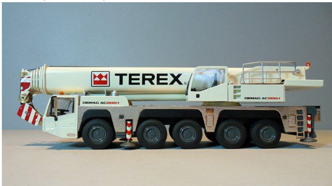
Слика 21. Изглед телескопске аутодизалице, [11]
