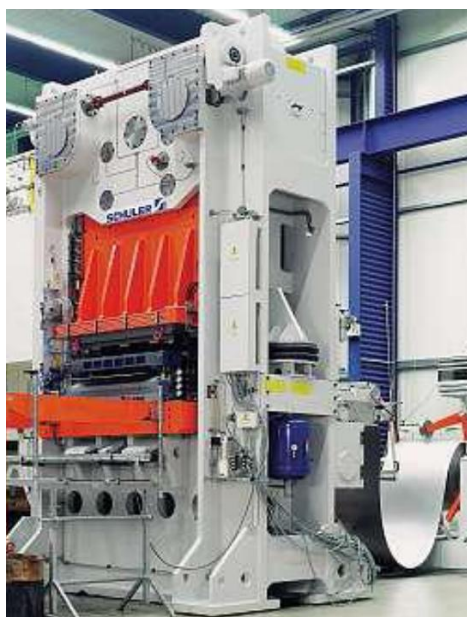
Слика 4.42 Изглед пресе једноструког дејства марке Schuler, модел PMK 1500 [1]
