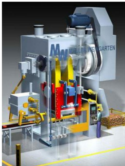
Слика 6.3 Вишепозициона преса марке Müller Weingarten: а) општа диспозиција машине; б) функционална шема машине; 1 - транспортни уређај, 2 - додавач припремке, 3 - избацивач у столу пресе, 4 - избацивач у притискивачу пресе, 5 - држач алата са доњом и горњом плочом и уређајем за загревање алата, 6 - уређај за замену алата [1]
