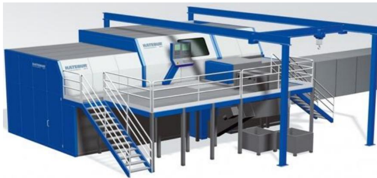
Слика 6.7 Аутоматска четворопозициона преса преса за топло запреминско деформисање, марке Hatebur, модел Hotmatic HM 75 XL [1]
