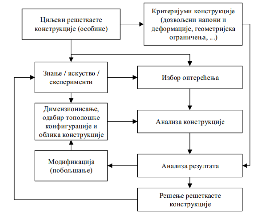
Слика 25 – Конвенционални поступак конструисања решеткастих носача [7]
