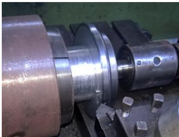
Слика 5.2 Операција обарање ивице 1.5/45^\circ
