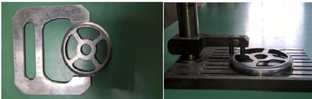
Слика 8 Једнострана диферцијална рачва (ИДЕ и НЕ ИДЕ), са отвором са једне стране и вертикални висометар са фиксираним уметцима за толеранцију висине (ИДЕ и НЕ ИДЕ), са једне стране
