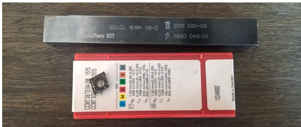
Слика 5.8. Држач ножа - леви и једностран ромбоидна позитивна плочица
