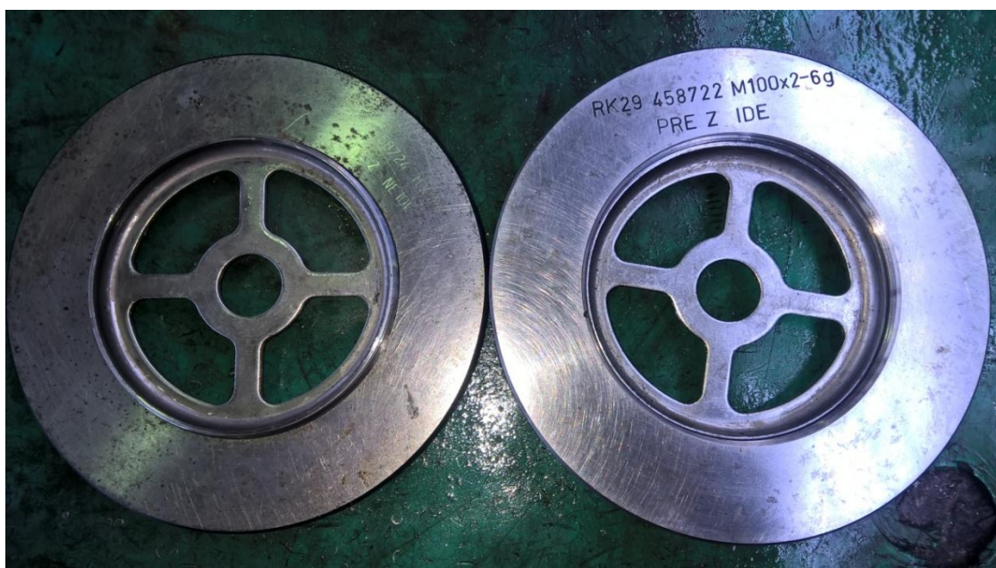
Слика 8.2 Навојни контролници за спољашњи навој M100x2-6g (ИДЕ и НЕ ИДЕ)
