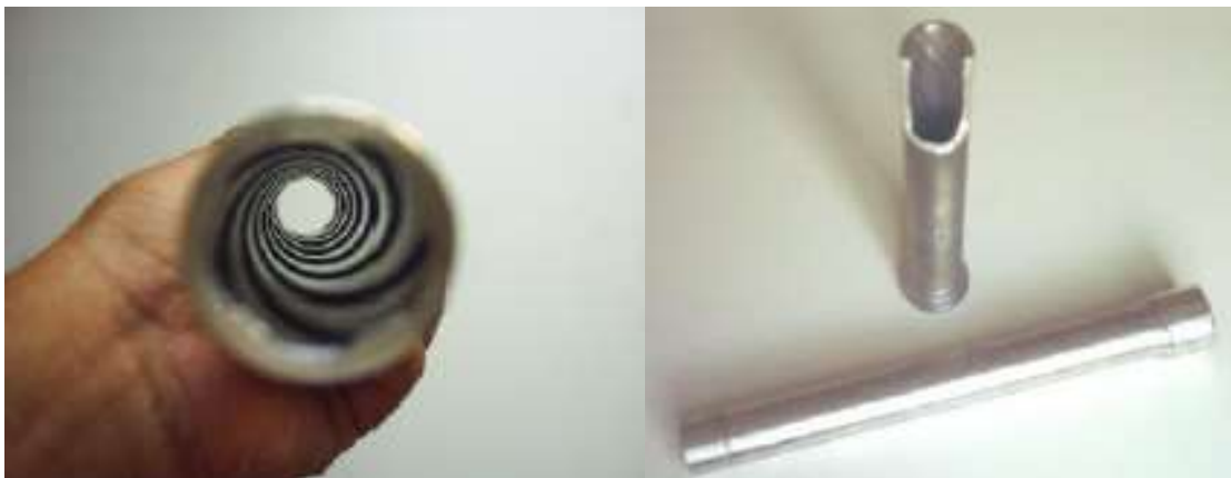
Слика 28. Изглед ожљебљења и завршене цеви оружја [3]
