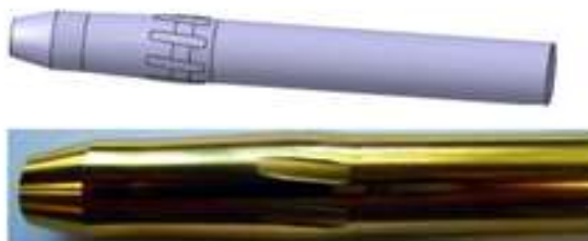
Слика 16. Приказ алата за ожљебљење протискивањем [3]
