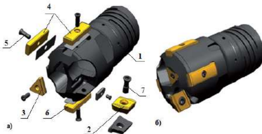
Слика 68. Алат за дубоко бушење са два ножа: а) делови главе за бушење: 1 – глава, 2 и 3 – резне плочице, 4 и 6 – вођице, 5 – вијак за причвршћивање вођица, 7 – вијак за прочвршћивање резне плочице, б) глава за бушење [3]
