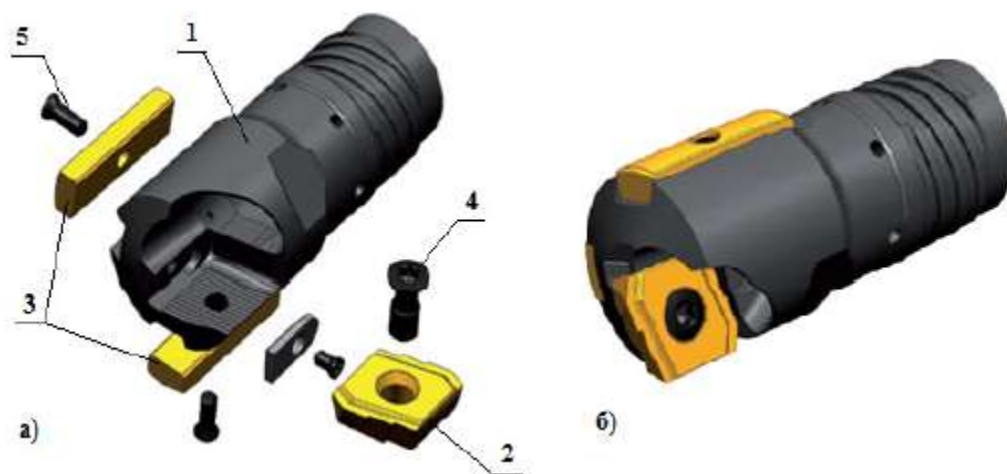
Слика 64. Изглед алата за дубоко бушење отвора средњих пречника са одређеним базирањем [3]
