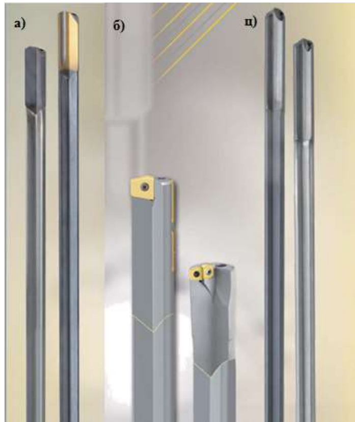
Слика 58. а) Глава од брзорезног или угљеничног алатног челика; б) Глава од конструкционог челика; ц) Монолитна глава од тврде легуре [9]
