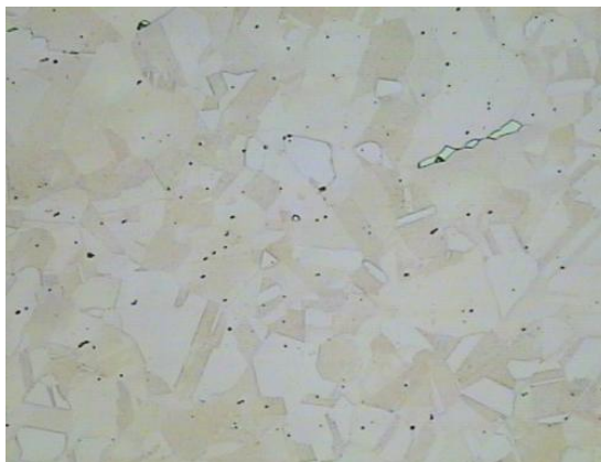
Слика 4.3 Микроструктура легуре бакра и цинка (месинга)
