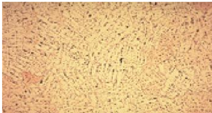
Слика 4.7 Микроструктура месинга са садржајем олова
