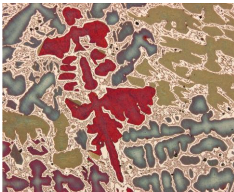
Слика 4.8 Микроструктура бронзе која има дендритну (у облику јелке) структуру
