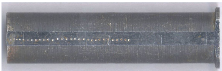
Слика 4.12 Приказ реалног узорка са мерним тачкама после извршеног мерења тврдоће
