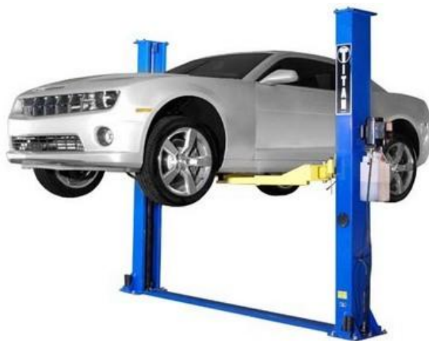
Слика 3.19. Двостубни вертикални подизач аутомобила [10]
