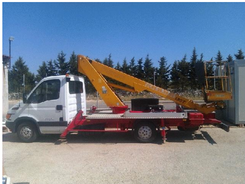
Слика 3.18. Подизна платформа на камиону „Ivesco 35.S.9” [10]
