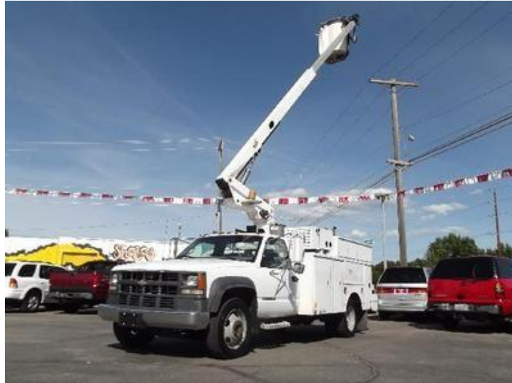
Слика 3.17. Хидраулична подизна платформа са стрелом на обртном стубу. [10]
