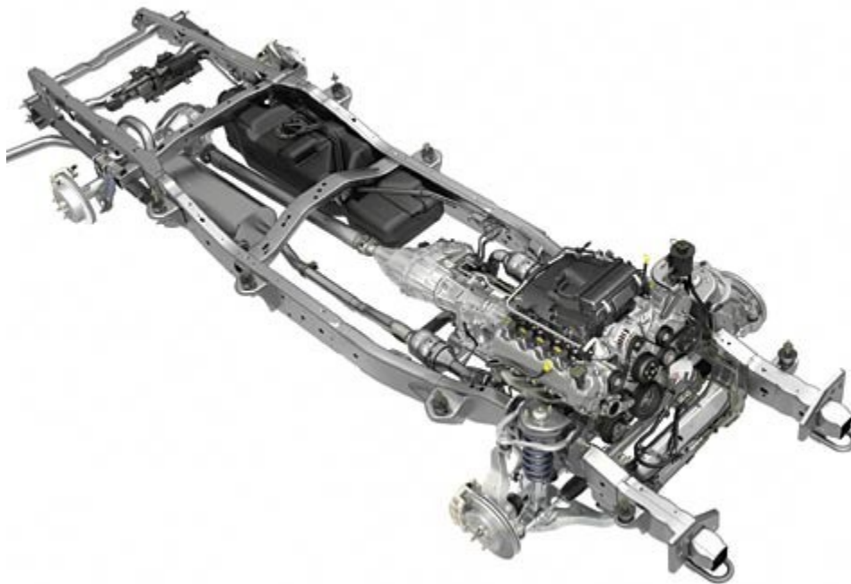
Слика 2.1: Шасија са погонским агрегатом, трансмисијом, огибљењем и кочионим системом
