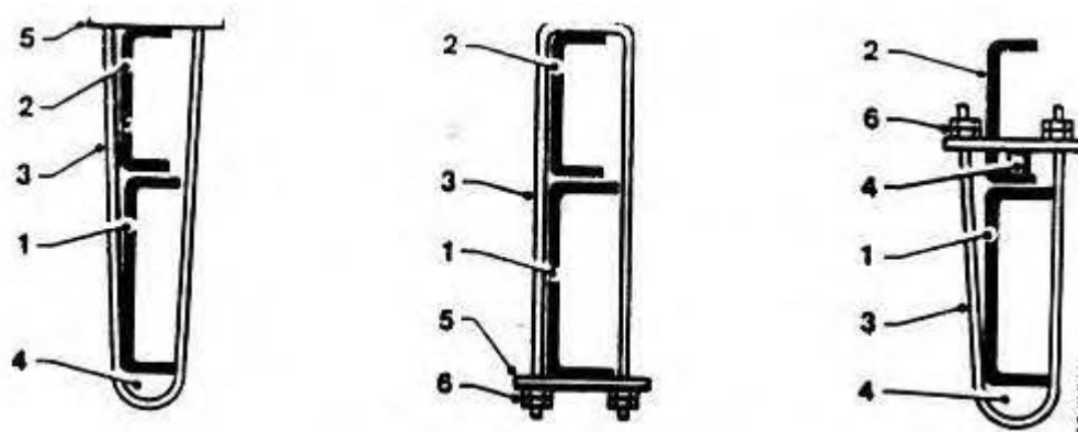
Слика 3.4 : Облици узенгија: 1. главни рам, 2. помоћни рам, 3. узенгија, 4. обликовани уметак, 5. подложна плочица, 6. навртка са осигуравајућом подлошком [3]
