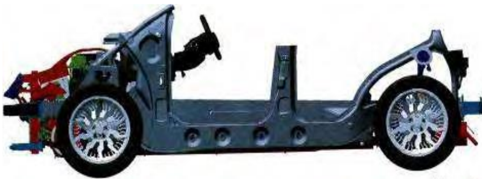
Слика 2.5: Оквир путничког возила у облику платформе намењен доградњи различитих облика каросерија
