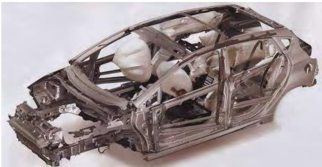
Слика 2.7: Скица самоносиве каросерије путничког возила
