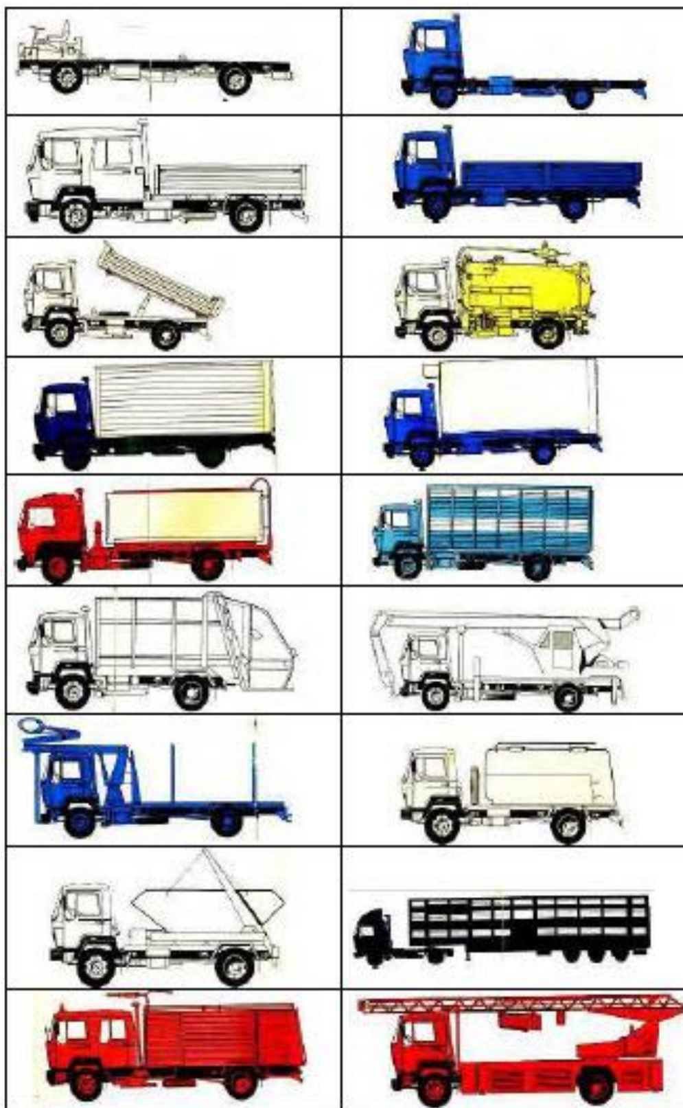
Слика 3.8: Различите надградње на истој шасији теретног возила
