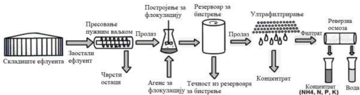
Слика 9. Технолошка шема третмана преосталог ефлуента [9]
