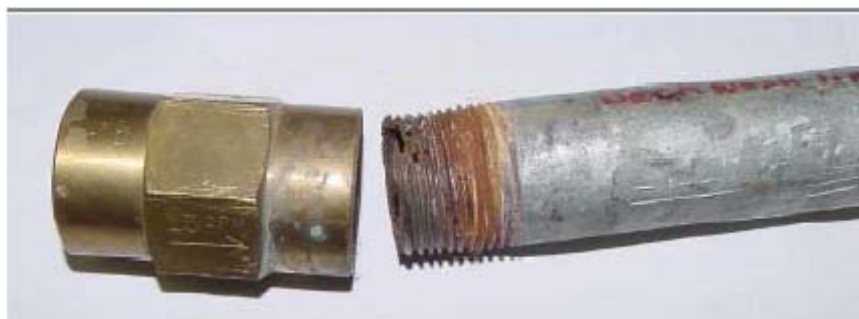
Слика 4.16 Пример галванске корозије
