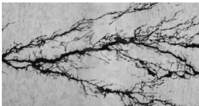
Слика 4.13 Изглед напонске корозије
