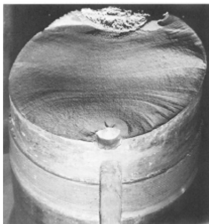
Слика 2.2 Заморни лом започет на жлебу за клин (доњи део) и завршни лом (горњи део)
