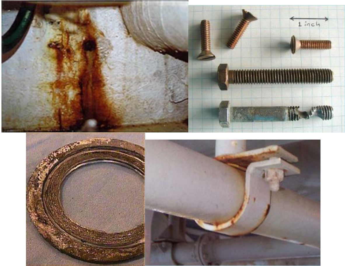
Слика 4.20 Изгледи машинских делова код којих је настала корозија у зазорима
