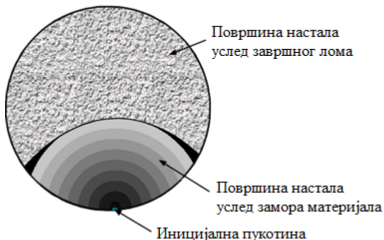
Слика 2.1 Површина лома услед затора
