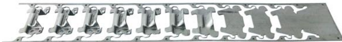
Слика 1.4. Процес израде комада приказан на траци од лима
