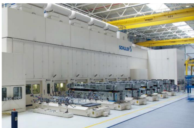
Слика 1.2. Пресерска линија и алати за израду компликованијих каросеријских делова у аутомобилској индустрији
