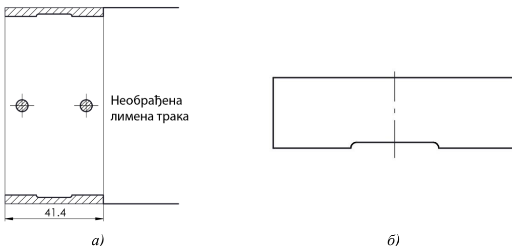
Слика 6.6. Први корак алата (а), профилни пробојач који уједно врши и улогу корачног ножа (б)
