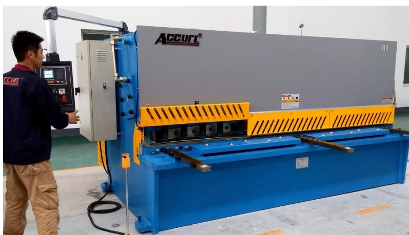
Слика 3.5. Типична индустријска машина (маказе) за одсецање лима коришћењем правих или косих ножева
