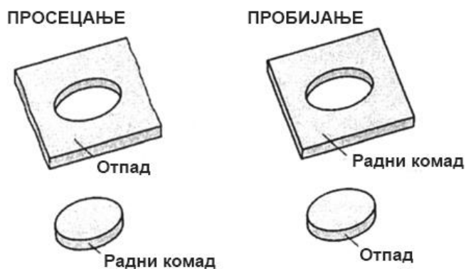
Слика 4.1. Основне разлике између операција пробијања и просецања, [8]
