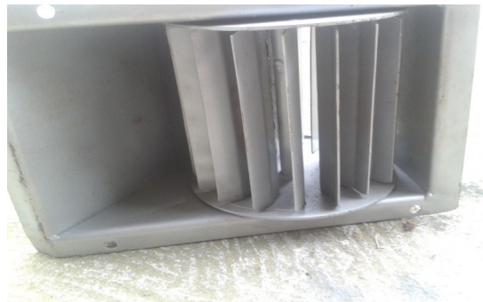
Слика 32. Изведени модел кућишта Банки турбине са радним колом
