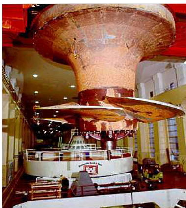
Слика 6. Кавитација на пропелеру
