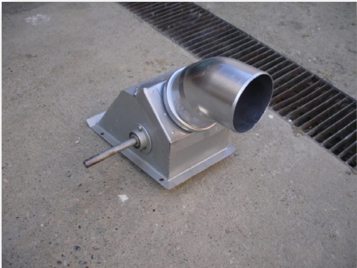
Слика 30. Изведени модел Банки турбине
