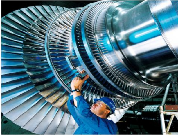
Слика 2.2.2.1 Ротор модерне парне турбине[6]
