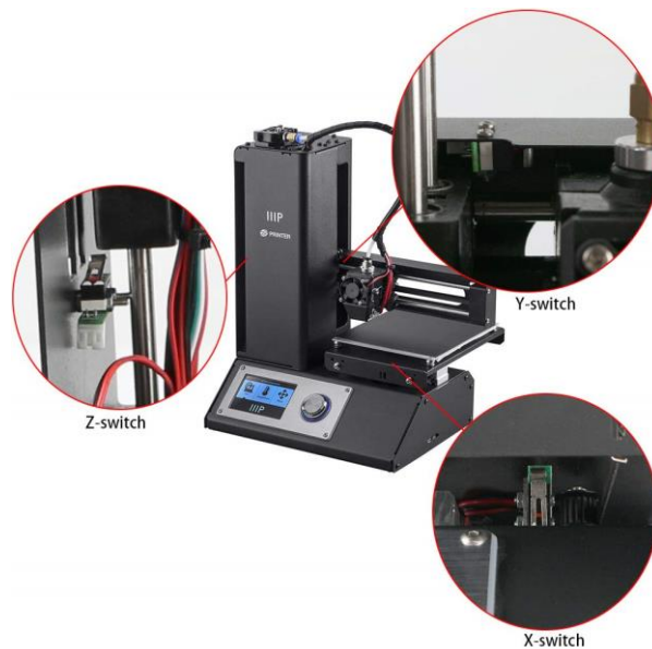
Слика 6 Позиција сензора на моделу принтера Monoprice Select Mini 3D Printer
