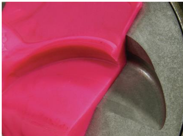
Слика 101: Пресек пластелина и растојање клипа и вентила
