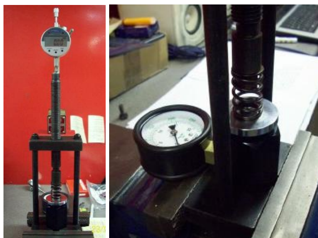
Слика 74: Испитивање опруга вентила
