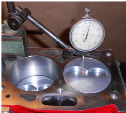
Слика 88: Довођење клипа у СМТ
