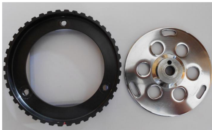
Слика 99: Конструкција подешавајуће ременице брегастог вратила
