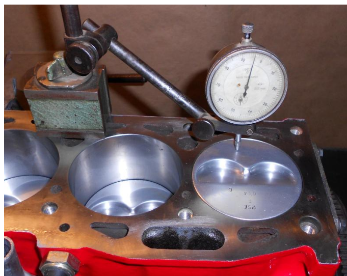
Слика 92: Довођење клипа у СМТ
