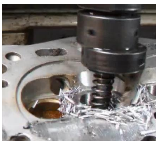
Слика 67: Обрада коморе за сагоревање
