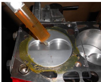
Слика 89: Пуњење удубљења на челу клипа течношћу
