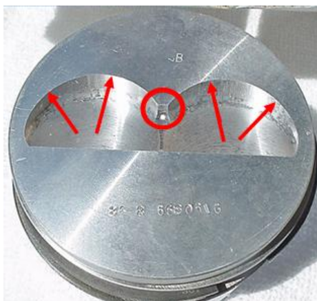
Слика 43: Потенцијална места настанка ненормалног сагоревања на челу клипа
