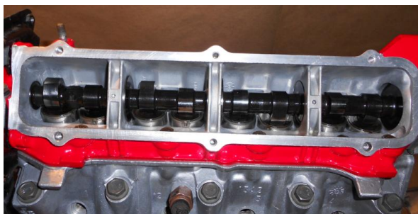
Слика 120: Уградња кућишта брегастог вратила
