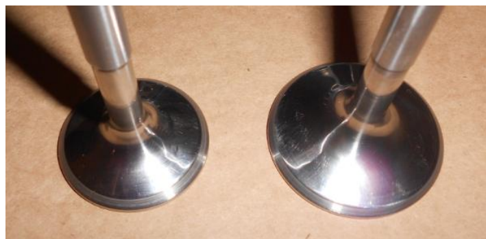
Слика 72: Полиране печурке вентила
