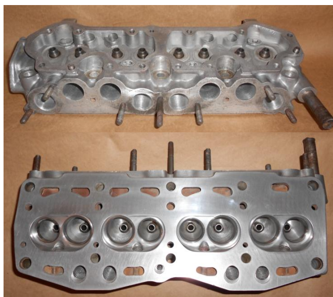
Слика 112: Изглед главе цилиндара са горње и доње стране
