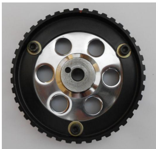
Слика 98: Подешавајућа ременица брегастог вратила
