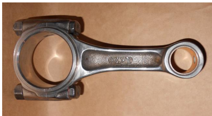
Слика 41: Клипњача спремна за уградњу
