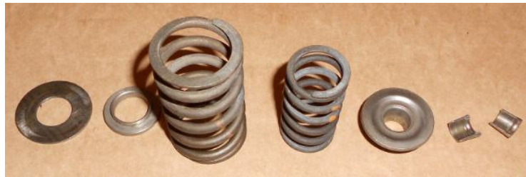
Слика 114: Опруге вентила и пратећи елементи
