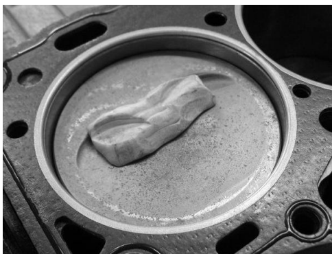
Слика 100: Провера растојања клипа и вентила пластелином
