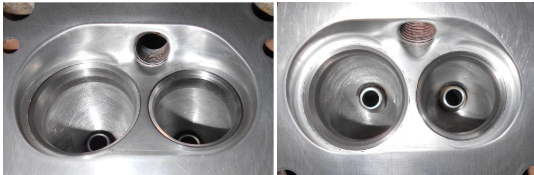
Слика 68: Реконструисана комора за сагоревање
