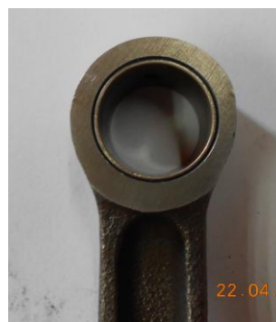
Слика 34: Обрада мале песнице клипњаче, технички цртеж а) [7] и изглед меле песнице клипњаче након обраде б)
