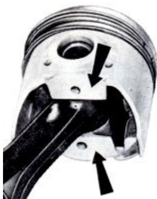
Слика 44: Обрада клипа у циљу изједначавања масе
