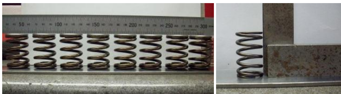
Слика 73: Провера опруга вентила
