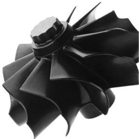
Слика 3.8 Ротор за рад при високим температурама од индустријске керамике израђен поступком врућег изостатичког синтеровања
