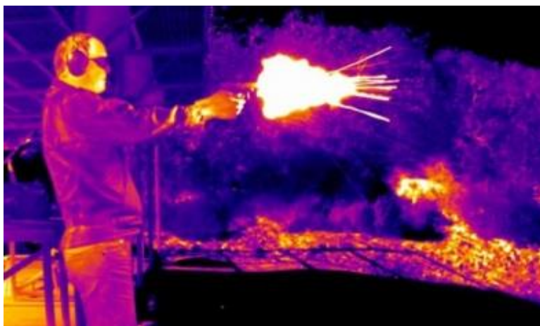
Слика 2.9 Примена термографске камере за снимање ефекта барутних гасова приликом опаљења из пиштоља
