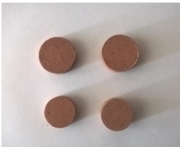
Слика 4.13 Узорци керамика-метал композита након печења
