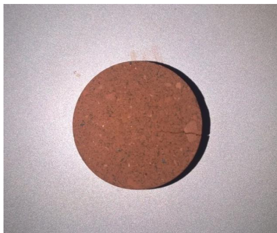
Слика 5.11 Узорак пречника \varnothing 25,25 \text{ mm} након испитивања на оптерећење од 50 \text{ kg} (5 дана потопљен у води)
