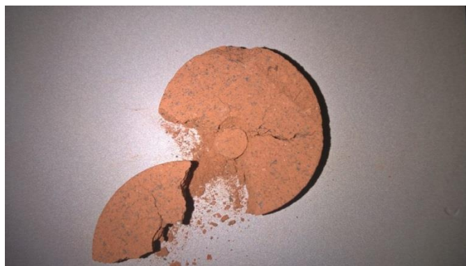
Слика 5.4 Узорак пречника \varnothing 30,25 \text{ mm} након испитивања
