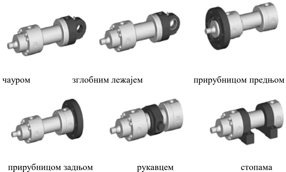
Слика 3.1. Начини причвршћивања цилиндара [5]
