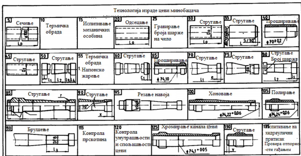
Слика 6.5. Пример технолошких поступака израде минобацачке цеви [1]
