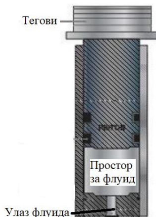
Слика 26. Изглед хид. акумулатора са теговима [11]
