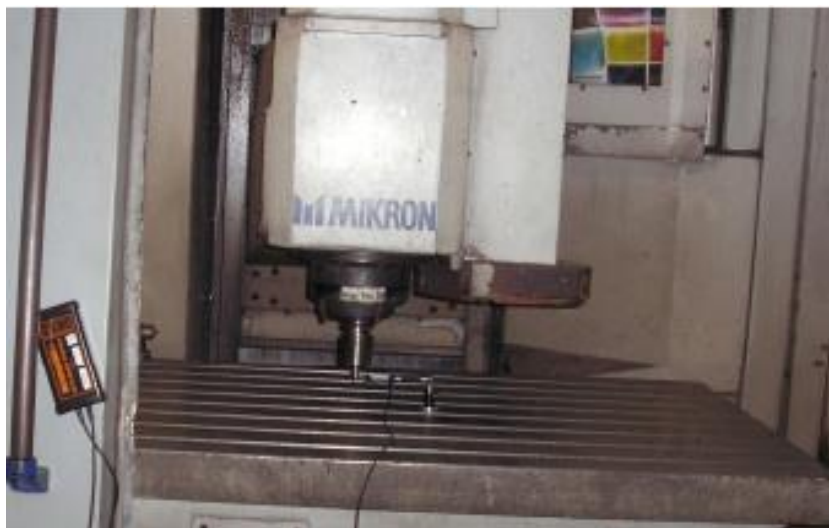
Слика 7.1: Мерење перформанси CNC глодалице Mikron VCP 1350 [12]
