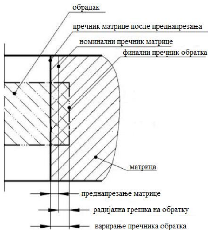
Слика 3.1: Утицај преднапрезања матрице на пречник обратка [3]
