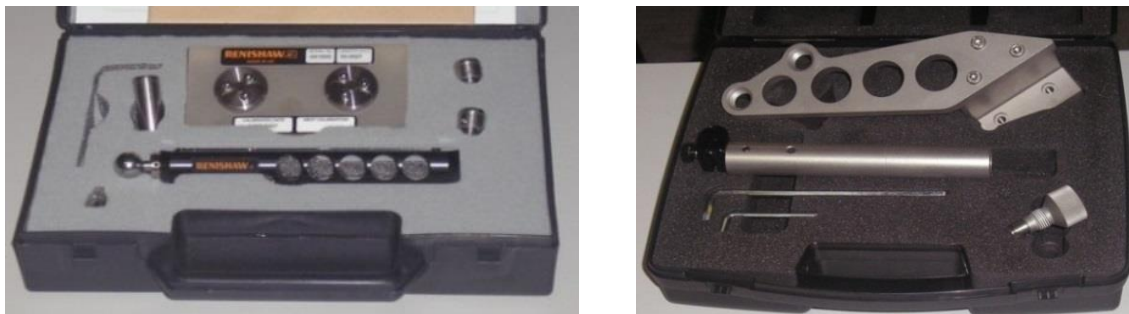
Слика 6.1: Додатак за мерење са малим пречником (лево), као и адаптером за мерење на CNC стругу (десно) [12]
