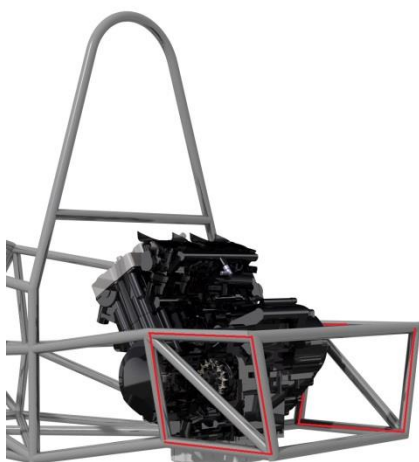
Слика 5.16 – Сегмент везе са системом ослањања
