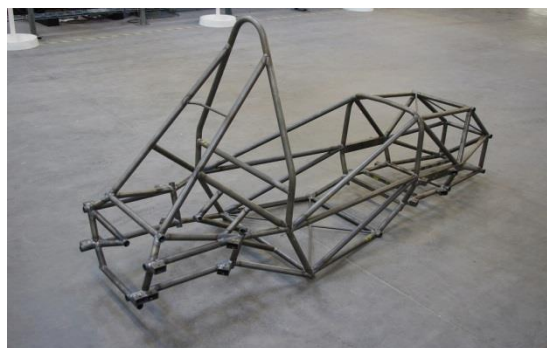
Слика 4.12 – Рам са неравном доњом линијом
