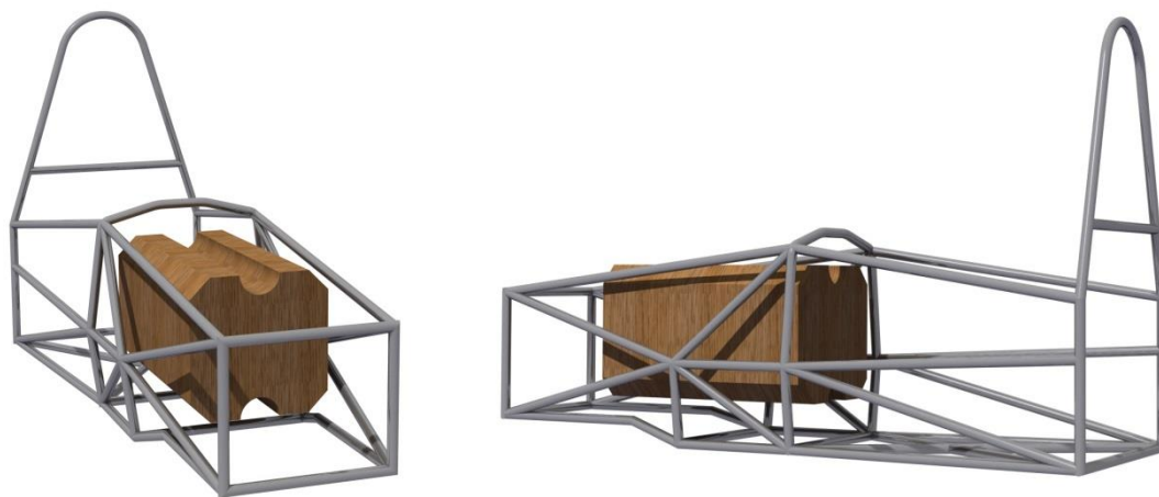
Слика 5.11 – Виртуелни тест пролаза вертикалног импактора дуж рама
