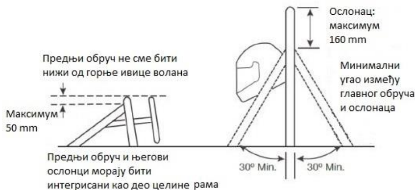
Слика 4.31 – Ограничења ослонаца главног и предњег обруча [15]
