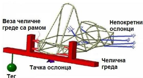
Слика 4.24 – Принцип теста торзионе крутости [7]
