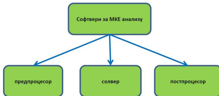
Слика 6.11 – Принцип рада софтвера за МКЕ [27]
