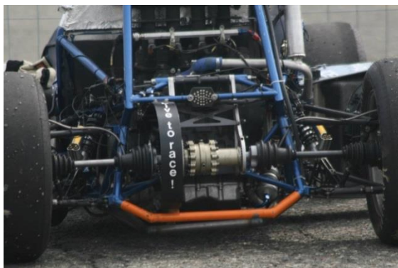
Слика 4.21 – Рам са скраћеним задњим делом
