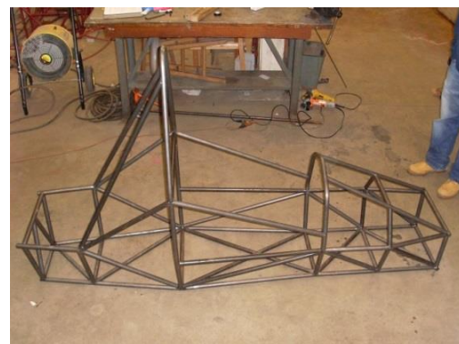
Слика 4.11 – Рам са равном доњом линијом
