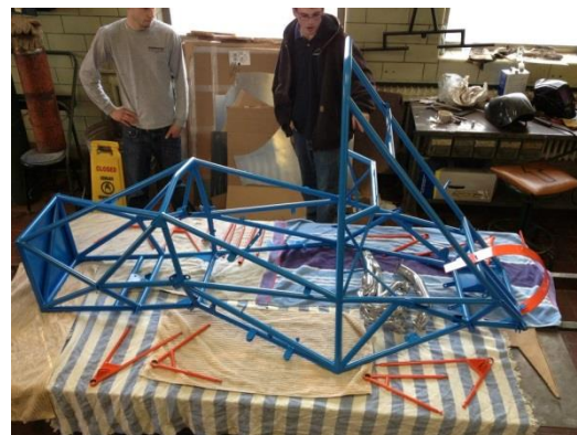
Слика 4.18 – Рам са оштрим задњим делом
