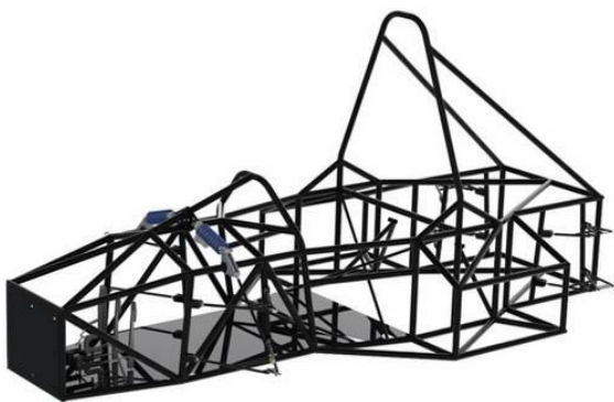
Слика 4.13 – Рам са додатном бочном конструкцијом
