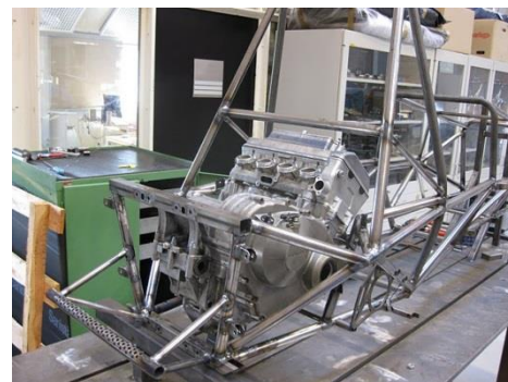
Слика 4.36 – Положај мотора на задњем делу рама
