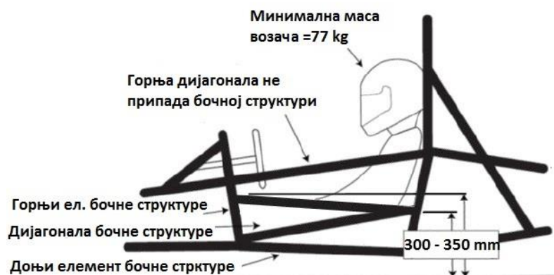
Слика 4.33 – Ограничења бочне структуре [15]
