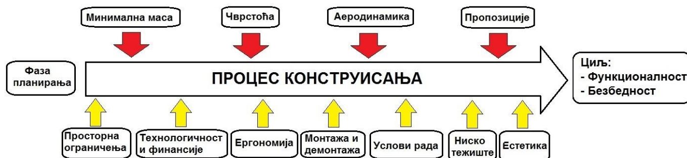
Слика 4.23 – Блок дијаграм утицајних фактора на процес конструисања
