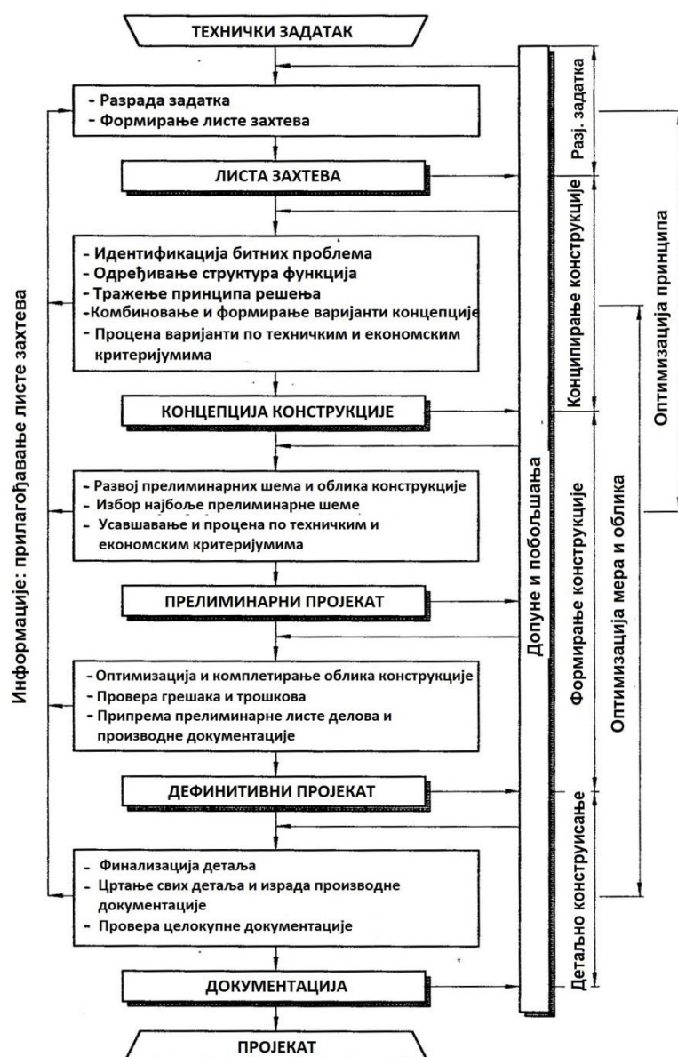
Слика 3.2 – Фазе процеса конструисања [13]
