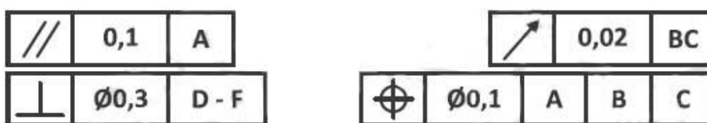
Слика 4.7.5.-Означавање толеранција положаја
