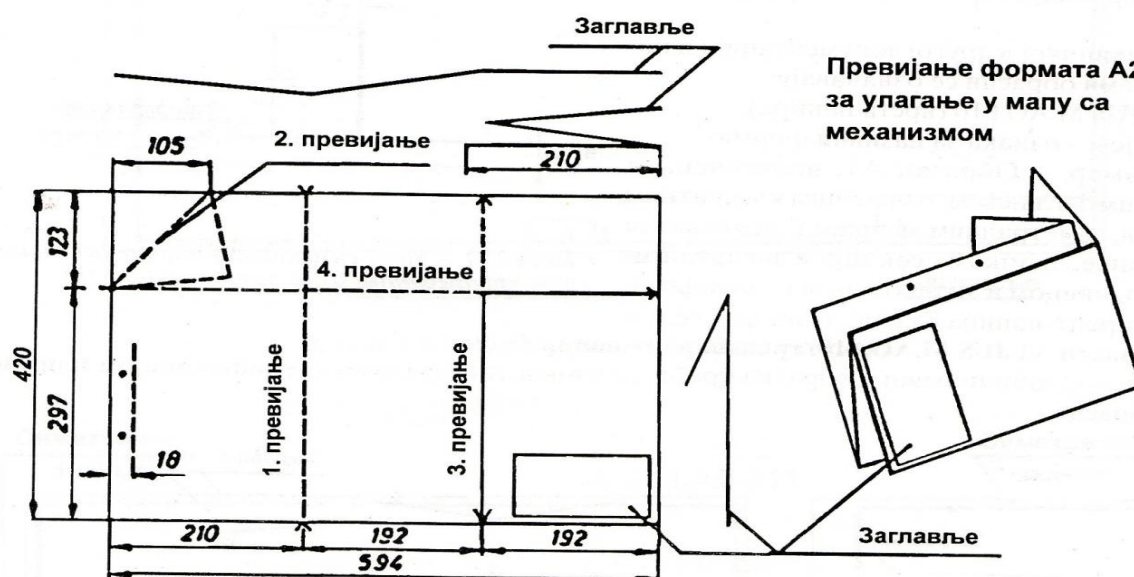
Слика 4.2.6.- Превијање формата A3 и A2 у мапу са механизмом
