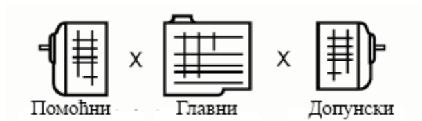
Слика 2.6. Мануелни мењачки преносник из више сегмената [1]
