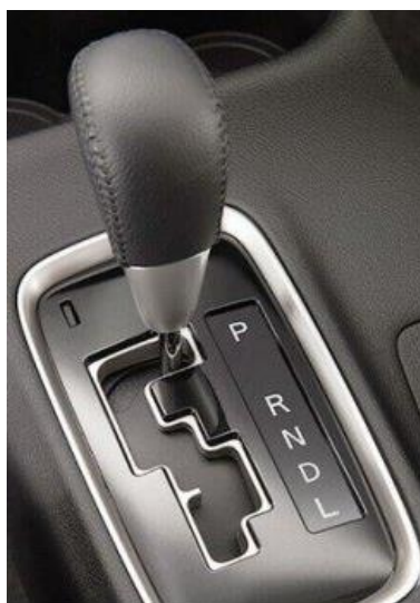
Слика 3.13. Командна ручица код путничких возила са CVT мењачким преносником [13]
