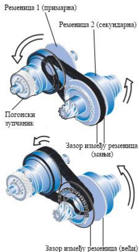
Слика 4.24. Пренос обртног момента мотора преко CVT мењачког преносник Audi Multitronic [30]
