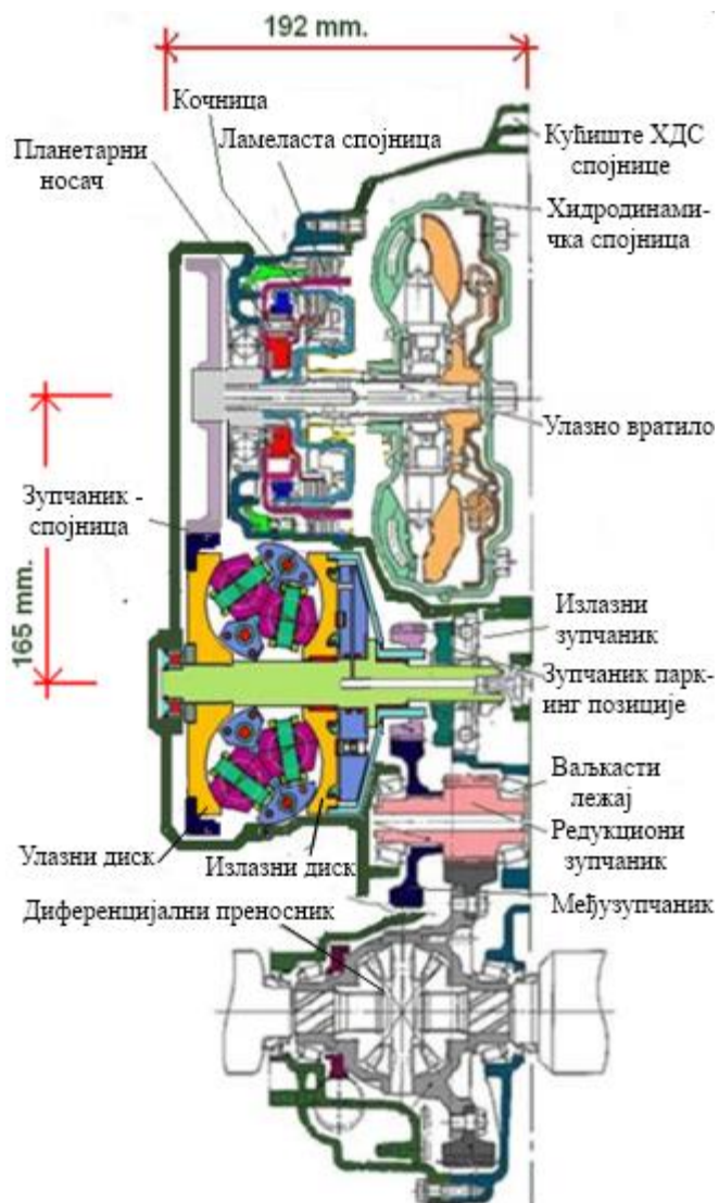
Слика 4.21. Jatco DFTV – CVT (Double Roller Full Toroidal) тороидни мењачки преносник са двоструким погонским ваљцима (250 Nm) [28]
