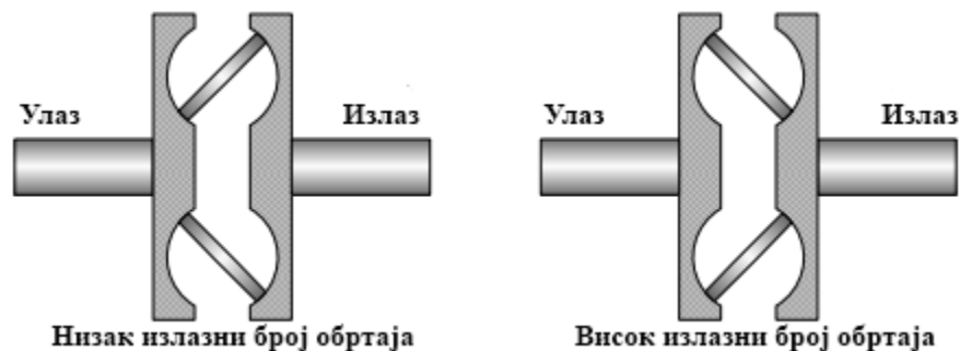
Слика 3.17. Концепт потпуно тороидне трансмисије [14]
