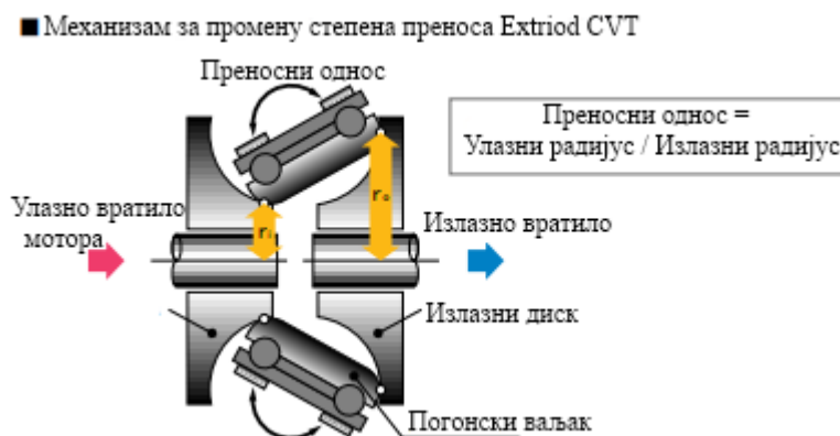
Слика 4.3. Механизам за промену степена преноса мењачког преносника Nissan Extroid CVT [23]
