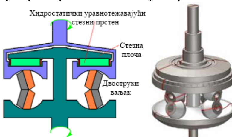
Слика 4.19. Концепт једноделног тороидног мењачког преносника са двоструким ваљцима [24]
