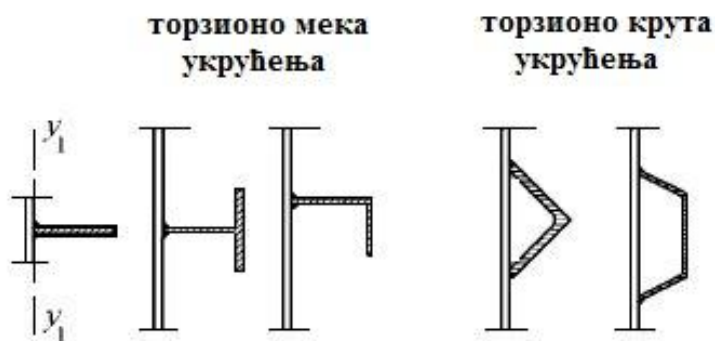
Слика 56. Подужна укрућења [4]
