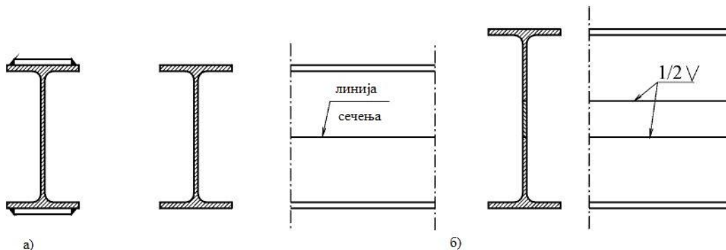
Слика 8. Пуни носачи састављени од два или више ваљаних профила [1]
