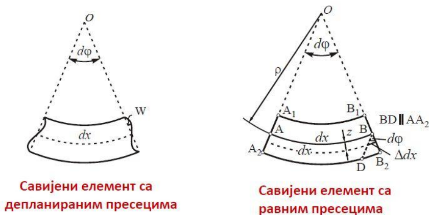
Слика 22. Савијени елементи са кривљењним и равним пресецима [9]
