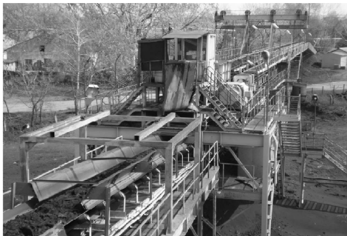
Слика 6. Тракасти транспортер Ц-11 (допрема угаљ са копа за потребе III фазе)
