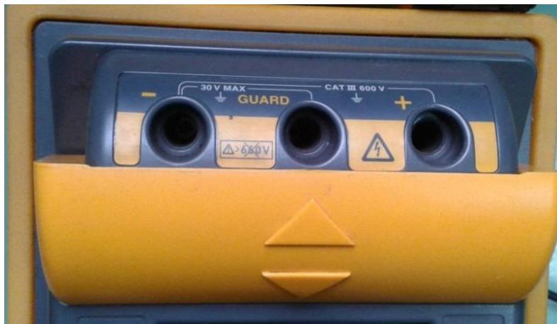
Слика 40. Места за прикључење каблова мерних штипаљки
