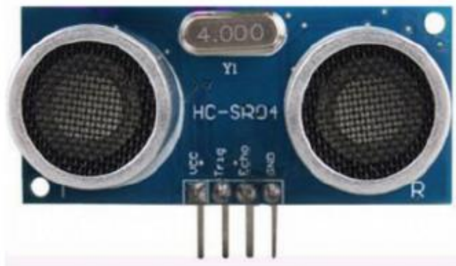
Слика 1.15 Ултразвучни сензор HC-SR04, коришћен при изради лабораторијског модела[10]
