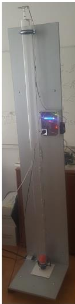
Слика 1.1 Лабораторијски модел система ваздушне левитације
