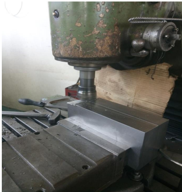
Слика 20. Трећа операција глодањем
