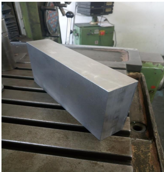
Слика 19. Изглед плоче након прве две операције обраде глодањем
