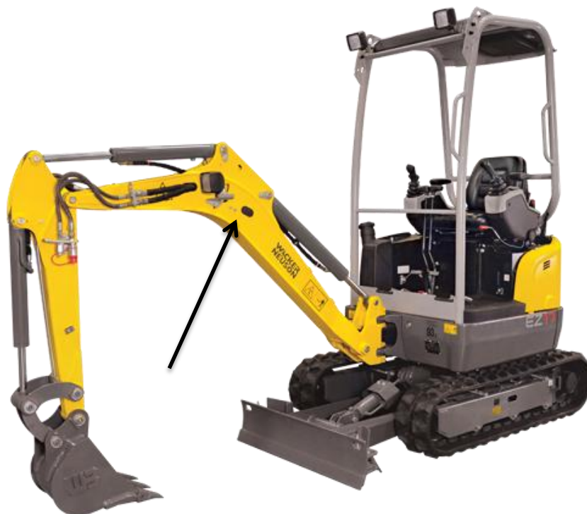
Слика 3. Сегмент руке багера Hubarm E13
