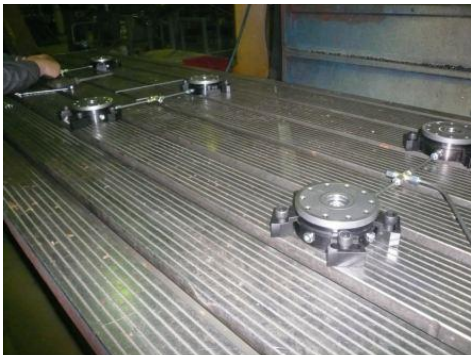
Слика 40. Изглед базних кућишта пинова након повезивања хидрауличке инсталације
