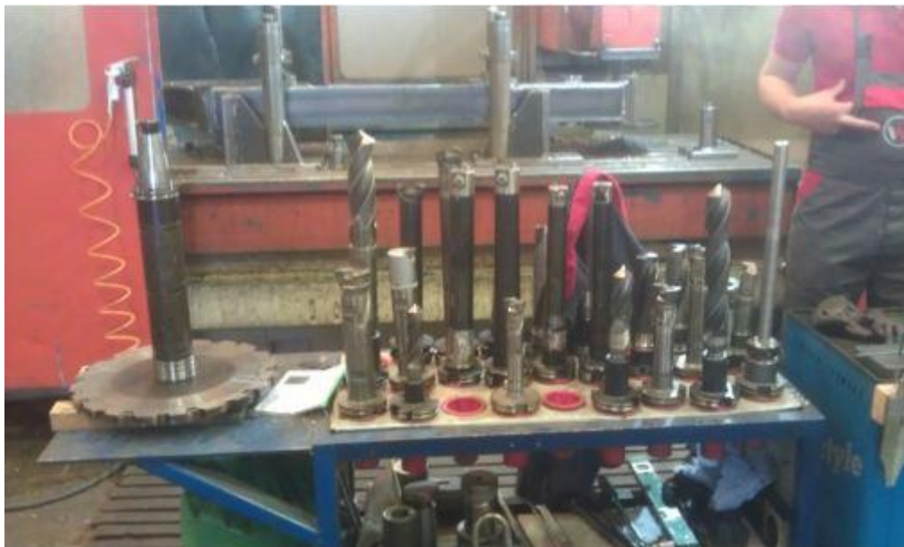
Слика 13. Резни алати са Sandvik диском Ø250
