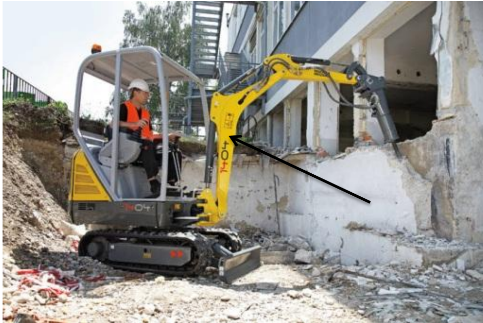
Слика 2. Стрелицом приказан сегмент руке багера Hubarm 1303
