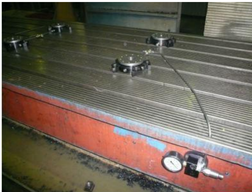
Слика 40. Изглед базних кућишта пинова након стезања
