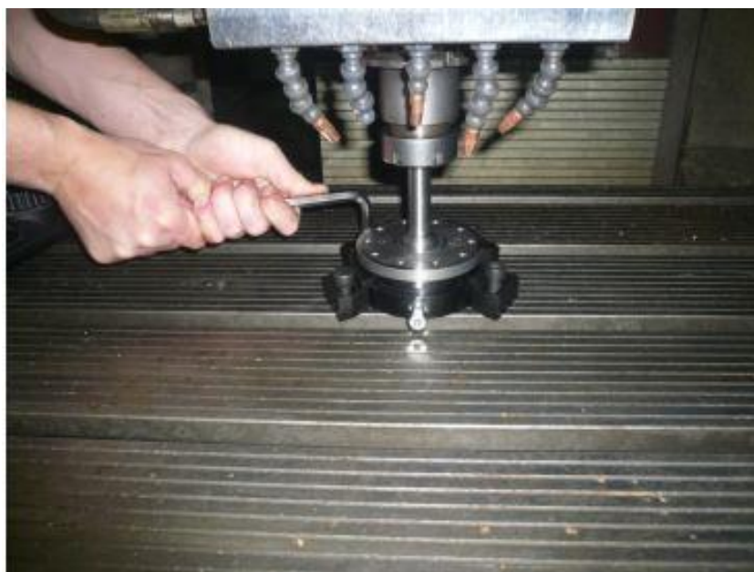
Слика 39. Затезање базних кућишта пинова
