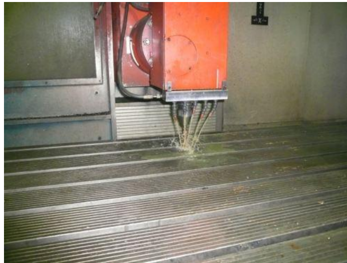
Слика 36. Израда отвора - бушење
