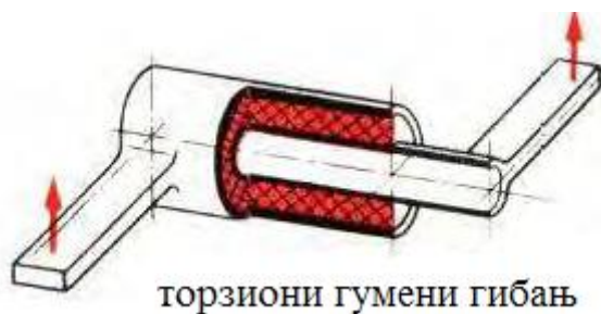
Слика 32 – Торзиона опруга са гуменим елементом [3]
