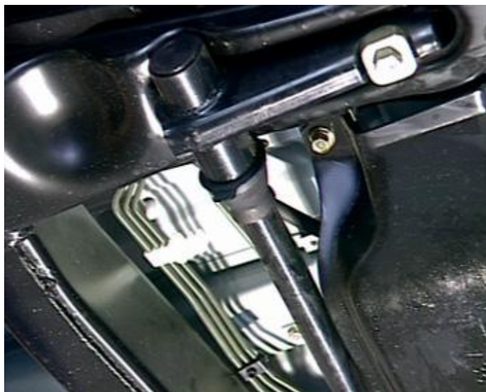
Слика 5 – Елементи пригушивања осцилација [3]
