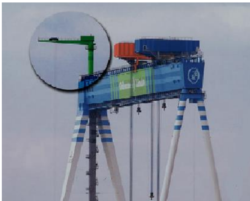
Слика 3.4 Пример комбинације порталне и конзолне дизалице [5]
