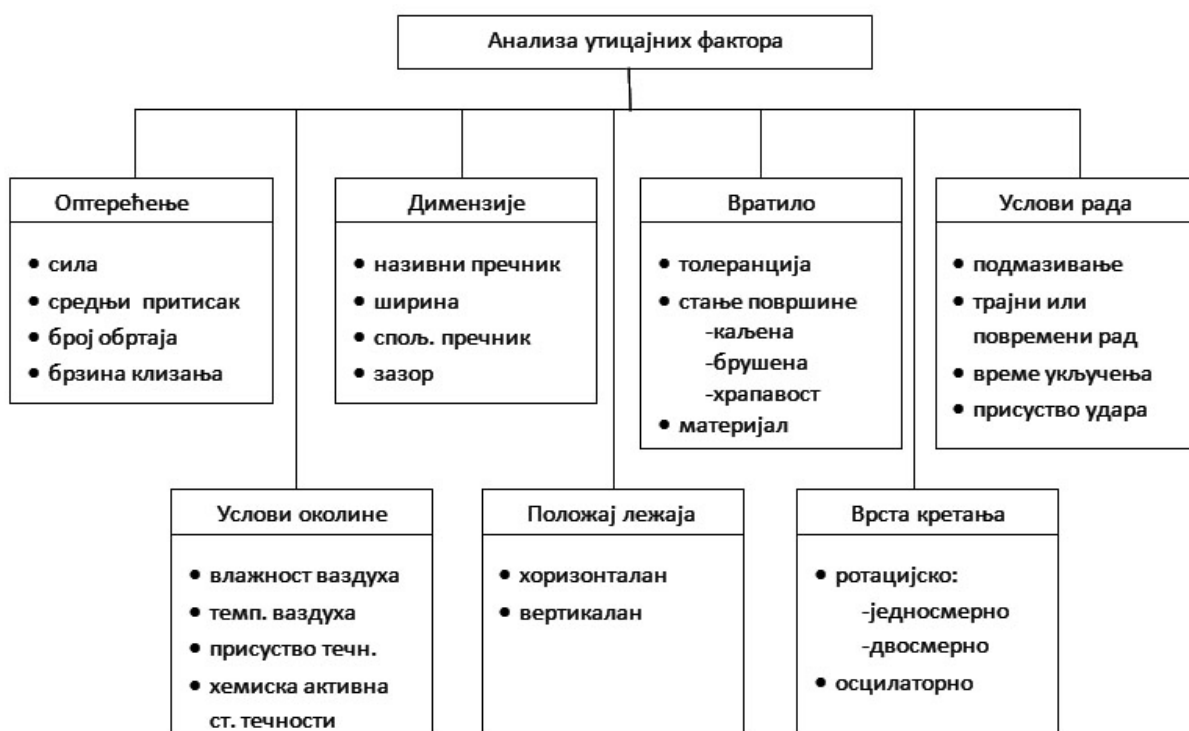
Слика 3.11. Класификација неопходних информација за испитивану конструкцију лежишта од термопластичних маса
