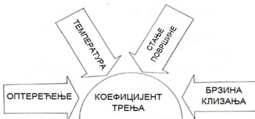
Слика 3.14. Неки од утицајних фактора на коефицијент трења термопластичних маса
