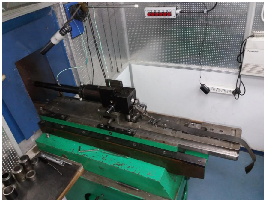
Слика 23: Изглед опитне цеви са флеш детектором [8]
